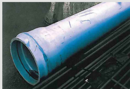
شکل ۱: رنگ رفتگی سطح لوله فشار بالا پی وی سی که به مدت پنج سال در محیط باز انبارش شده است. این لوله همه آزمون های مورد نیاز که بر روی لوله جدید تست می شود را پاس کرد.
