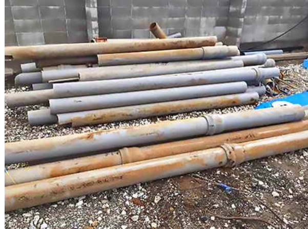
شکل ۶. لوله‌های PVC خارج شده از خاک بعد از ۲۴ تا ۴۳ سال کارکرد جهت بررسی میزان عملکرد و دوام
